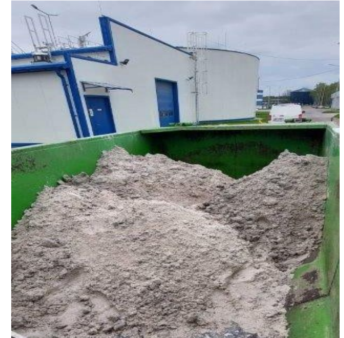
Struwit wytrącony z instalacji na etapie rozruchu technologicznego.
